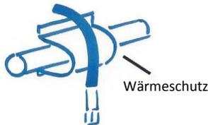
Hohe Außentemperaturen verringern die Lebensdauer der Schläuche. Bei der Verlegung in unmittelbarer Nähe zu hitzeabstrahlenden Quellen werden daher Schutzbleche, Schutzummantelungen sowie Schläuche in spezieller Ausführung empfohlen.
